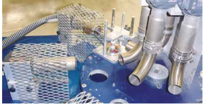
Calentador de aire en una mesa giratoria para la producción de bombillas.
